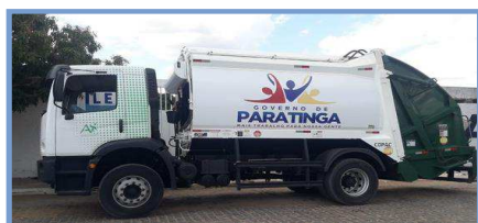
Figura 3-22 - Caminhão compactador Fonte: COBRAPE (2021)
