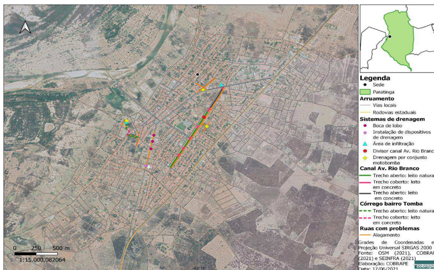
Figura 3-51 – Estruturas relacionadas à drenagem na sede municipal de Paratinga
