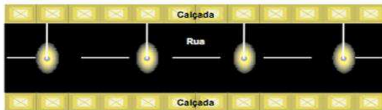
Figura 1 - Arranjo unilateral das luminárias
